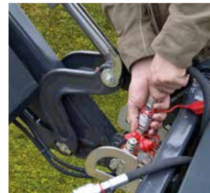
3 Připojení hydraulického spojení.
