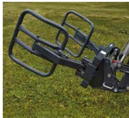
2 Zaklopení nářadí – zajišťovací mechanismus se automaticky zavakne.
