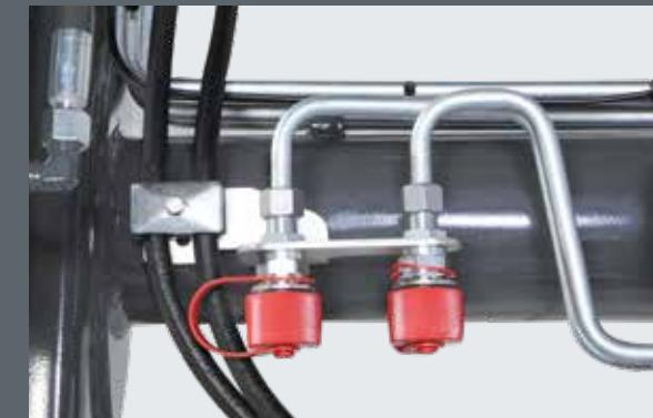
Efektivní používání hydraulického nářadí – díky třetímu řídicímu okruhu k tomu není potřeba žádná další zvláštní řídicí jednotka.
