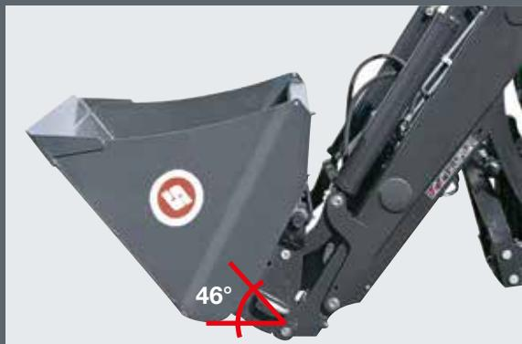
Vše zůstane uvnitř: díky vynikajícímu nabíracímu úhlu nevznikají při nakládání žádné ztráty vysypáním.
